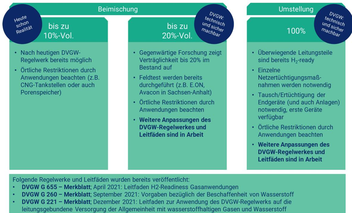
Abbildung 4-1: Beimischung von H<sub>2</sub> in das bestehende Erdgasnetz
